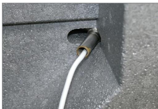
Abbildung 10: Temperaturfühler bis zum Anschlag eingeschoben
