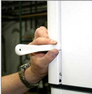
Die Verkleidungsbleche werden in umgekehrter Montagerihenfolge demontiert (siehe Abbildung 13).
