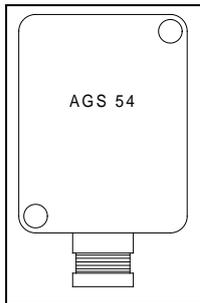
Der Außenfühler (Lieferumfang) muss immer senkrecht (auch bei provisorischer Montage) mit der Kabeleinführung nach unten montiert werden. Die Verschraubung muss anschließend so weit angezogen werden, dass das Kabel dichtend eingeführt und kein Wasser in das Gehäuse eindringen kann.
