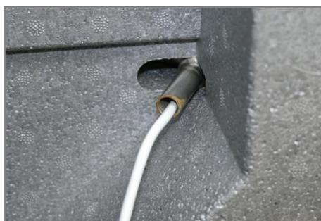
Abbildung 11: Temperaturfühler bis zum Anschlag eingeschoben
