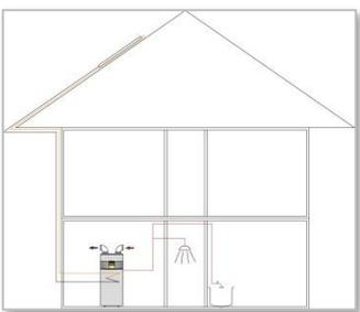
Die Trinkwasser-Wärmepumpe kann in Verbindung mit Solarkollektoren, externen Wärmeerzeugern, Heizkesseln oder sonstigen Energiequellen betrieben werden. Dafür die Baugröße 300 mit Zusatzwärmetauscher für Solar- oder Heizkesselanwendung lieferbar. Details entnehmen Sie den technischen Daten.
