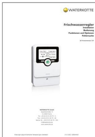
Die Wohnungsstation 2.0 ist mit einem Trinkwassererwärmer ausgestattet. Dieser wird elektronisch geregelt. Der wartungsfreie Frischwasserregler 2.0 ist ausschließlich zur Steuerung und Überwachung des eingebauten Trinkwassererwärmers vorgesehen.
