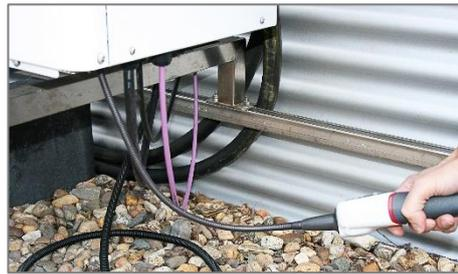
Abbildung 1: Gaslecksuchgerät
